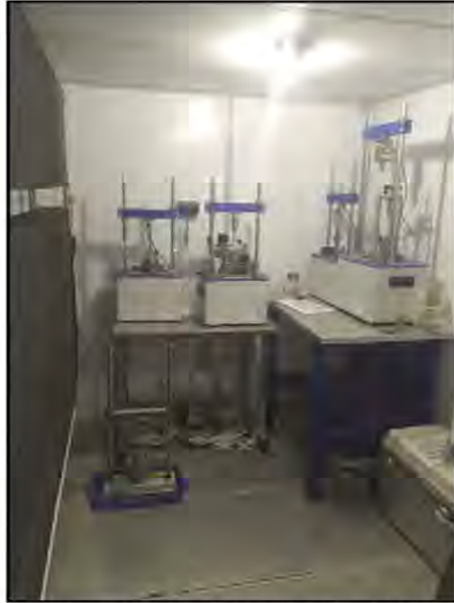
Рисунок 3.2. Лабораторная морозильная камера с приборами для сдвиговых, компрессионных и одноосных испытаний грунта
