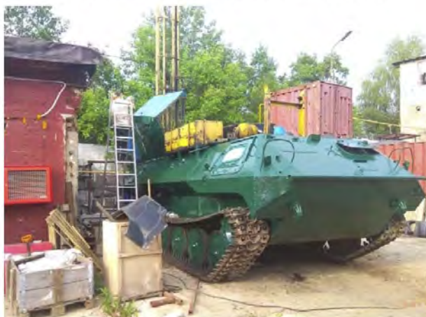
Рисунок 3.3 – Буровая установка УРБ-2А2 на базе МТЛБ
