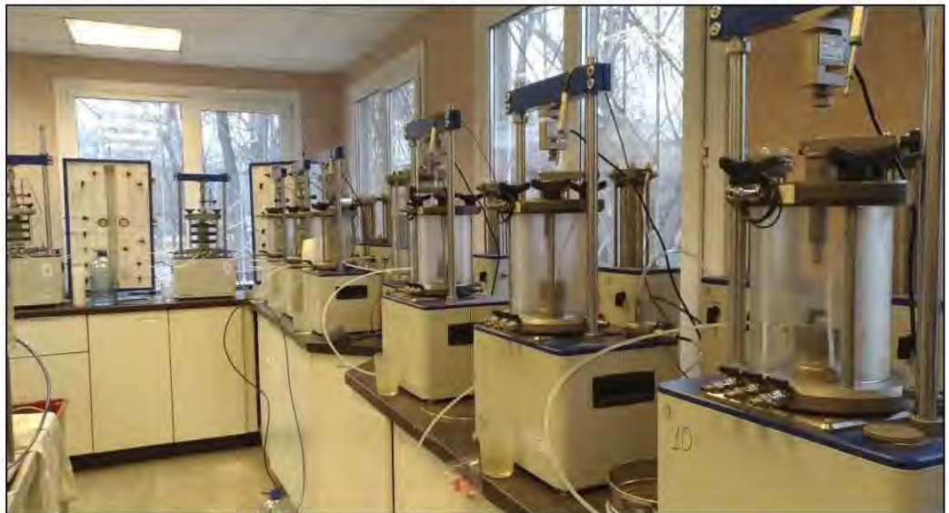
Рисунок 3.7 – Прибор для испытаний грунта методом трехосного сжатия
