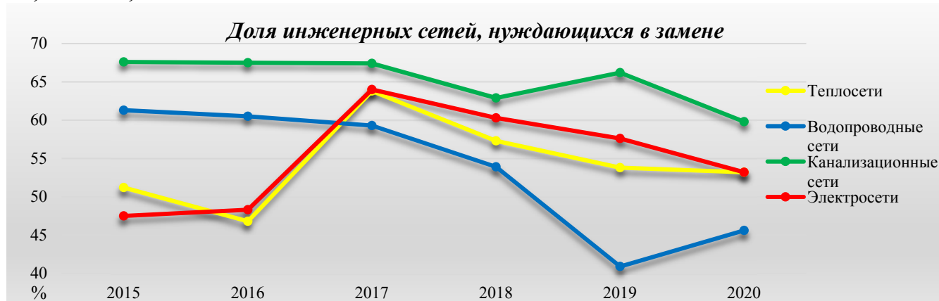
График. Доля инженерных сетей, нуждающихся в замене, %
